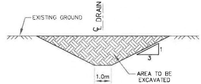
TYPICAL DRAIN CROSS SECTION IN EARTH
